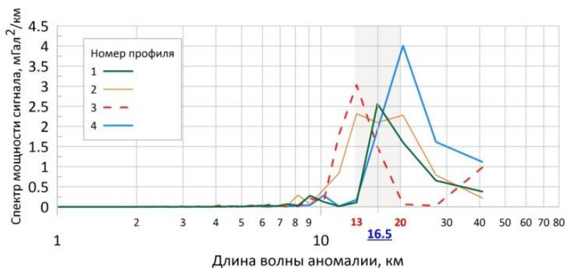
Рис.27. Графики зависимости спектральной плотности мощности разностей «съемка–модель» по тестовым профилям от длин волн аномалий. Выделен диапазон длин волн 13–20 км с повышенной погрешностью..
